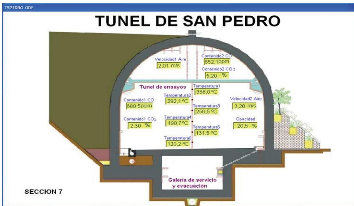
Figura 9. Esempio di visualizzazione dei dati con il sistema SCADA
