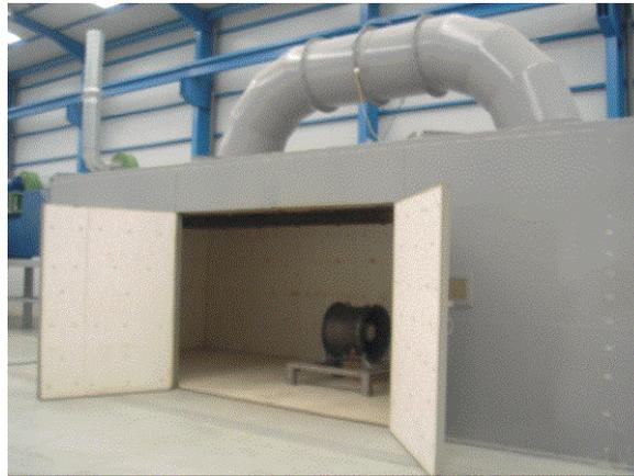
Figura 14. Test a 400° C eseguito per Autostrade per l'Italia S.p.A. – 1° lotto del nuovo tracciato della Variante di Valico, Autostrada FI-BO
