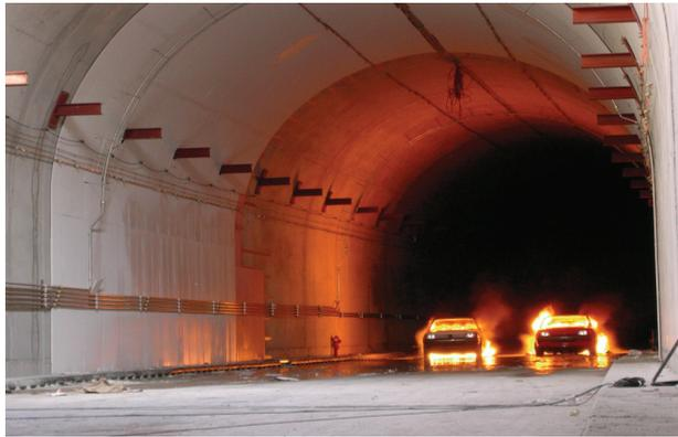
Figura 3. Prova di incendio in scala reale
