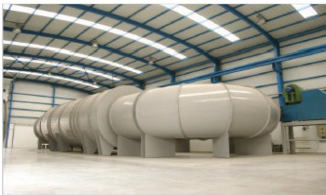
Figura 11. Banco di prova con ricircolo dell'aria
