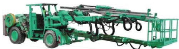
Figura 12. Jumbo convenzionale 2 b con cestello
