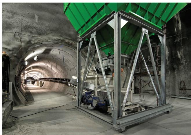
**Figura 17. Il nastro in galleria e la tramogga di carico**
