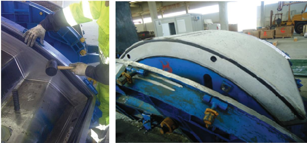
Figura 14: Esempio di montaggio della guarnizione ancorata e vista del prodotto finito
