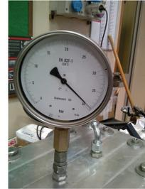
**Figura 11. Guarnizione Sparvo e prova idraulica sulla stessa**
