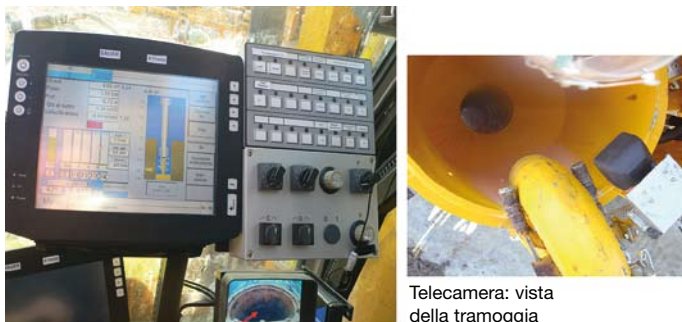
Telecamera e schermo separato per visualizzare la tramoggia ed il livello del calcestruzzo
