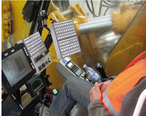
Figura 8 Vista della "sala di controllo" installata a bordo macchina
