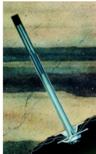
Figura 7 - Principio del meccanismo a frizione (Split Set)
