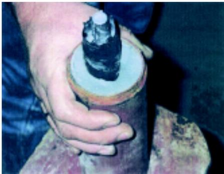
**Figura 22** - Pull test su un CT-Bolt iniettato: rottura della barra al suo valore di carico limite (non sussistono fenomeni di slittamento della guaina)
