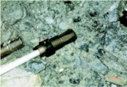
Figura 32 - Particolare della testa ad espansione
