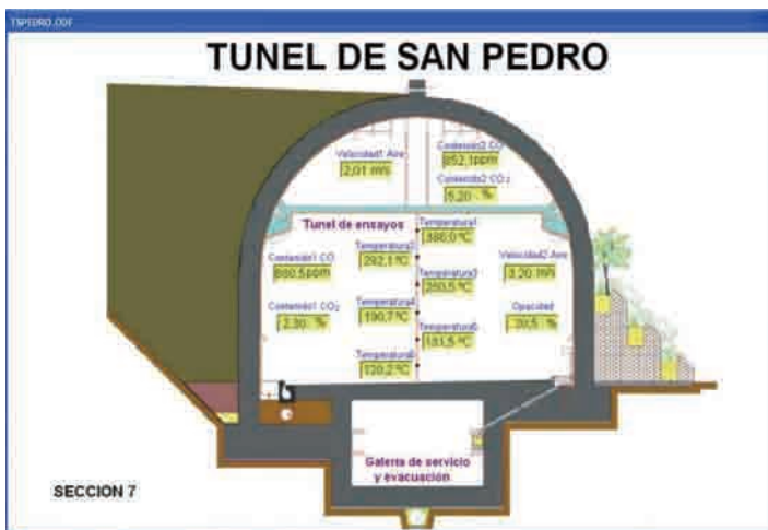
Esempio di visualizzazione dei dati con il sistema SCADA.
