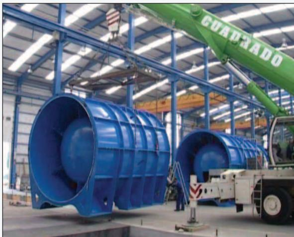
Figura 13 - Un ventilatore da 4,2 m di diametro e 3,5 MW di potenza, con angolo di calettatura delle pale variabile oleodinamicamente
