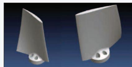
Figura 4 - Il lato di pressione e di aspirazione della pala 3D
