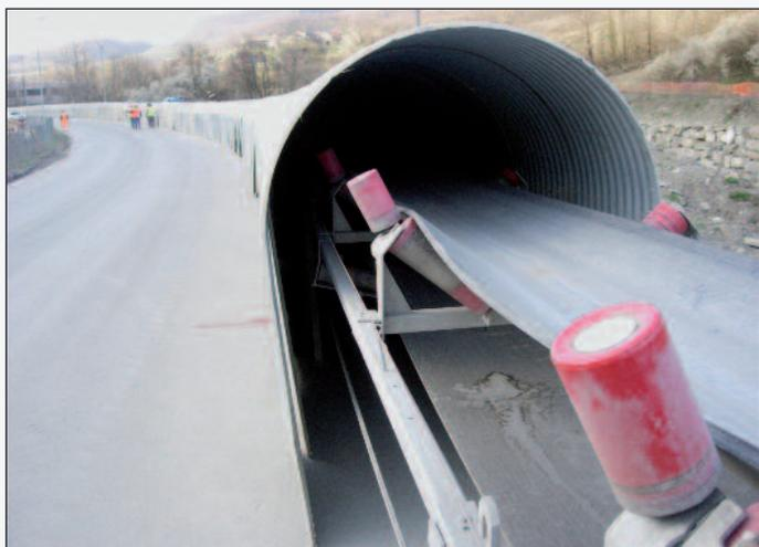
Figura 2 - Il nastro trasportatore blindato
