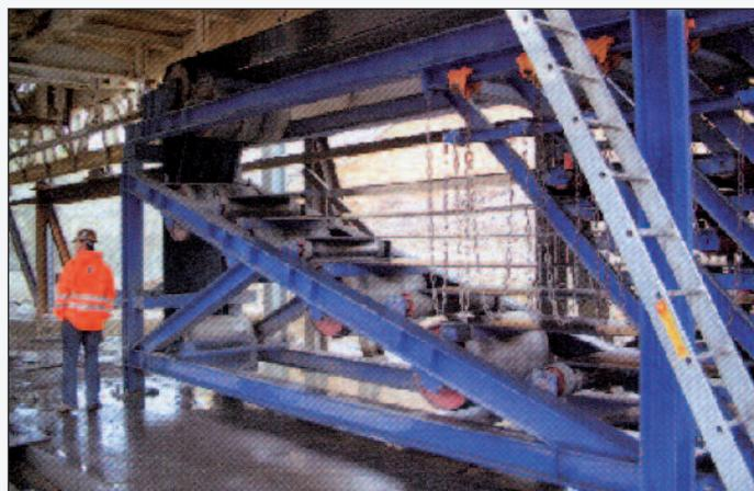
Figura 4 - Il magazzino del nastro Marti Technik, installato sotto una struttura portante in acciaio
