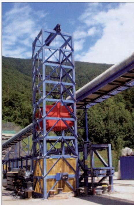
Figura 5 - La torre contrappeso Marti Technik: l'argano di tiro è posizionato dalla parte opposta dell'attraversamento fluviale (Brennero)
