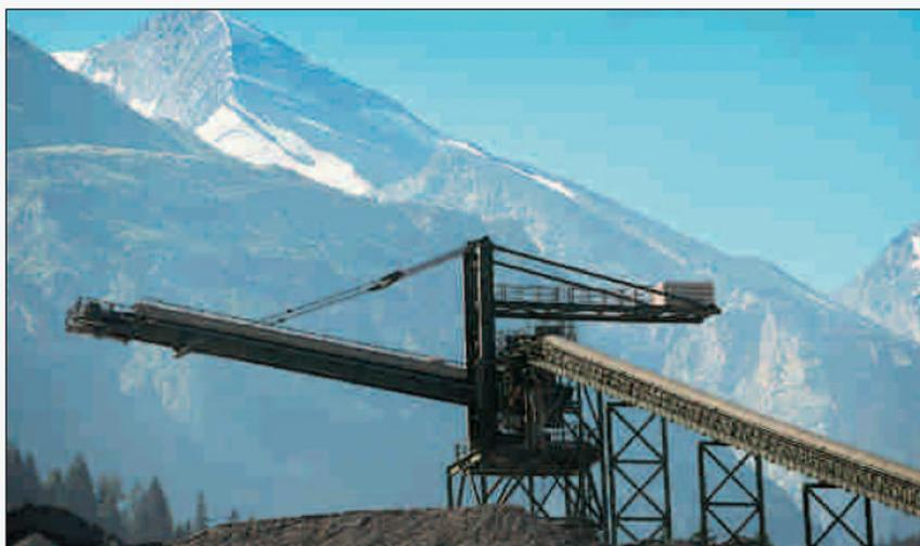
Figura 9 - La sistemazione a parco mediante stacker (Lötschberg)
