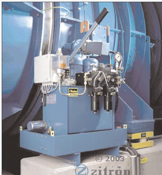
Il sistema idraulico automatico di reversibilità delle pale (Rennsteig)
