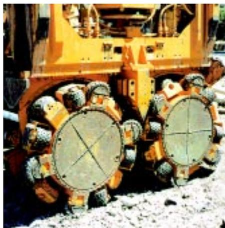
Figura 11 - Testa fresante munita di roller bits
